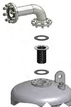
Desmontar la criba de agente secador
